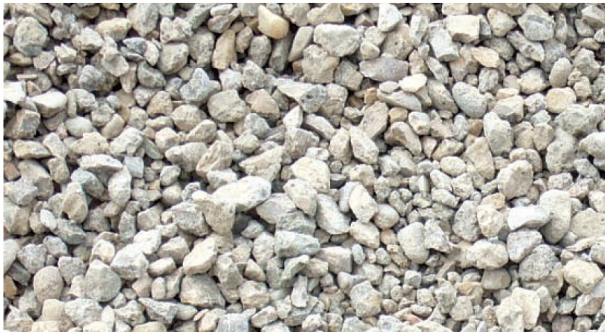
Abbildung 2: Beispiel; Gesteinskörnung aus gebrochenem Altbeton (Broschüre „Transportbeton unter Verwendung von Gesteinskörnungen nach Typ 2“, Land Baden Württemberg).
